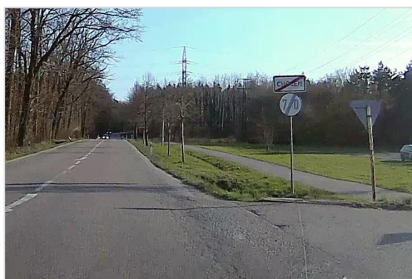
160/ Nadbytečná značka B 20b je ukončena koncem obce i hranicí křižovatky (II/357: Choceň, Vysokomýtská)
