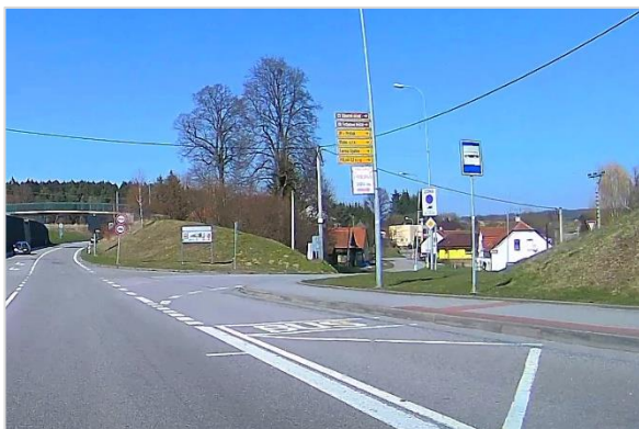
129/ Použití značky IJ 4c jako zastávkového sloupku, kde má být umístěna značka IJ 4a (I/43: Opatov, zastávka Opatov, u rybníka)
