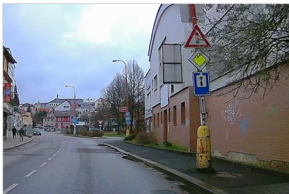
140/ Nepovolená kombinace značek se značkou P2, vše navíc překryté vegetací, která znemožňuje viditelnost z více než 10 metrů (II/360: Ústí nad Orlicí)
