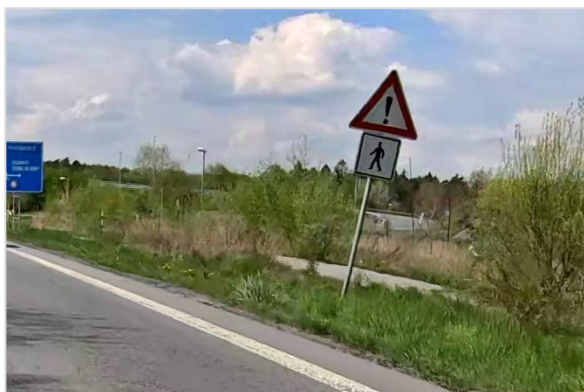
161/ Použití značky jiné nebezpečí s dodatkovou tabulkou upozorňující na chodce (II/322: Dašice – Pardubice)
