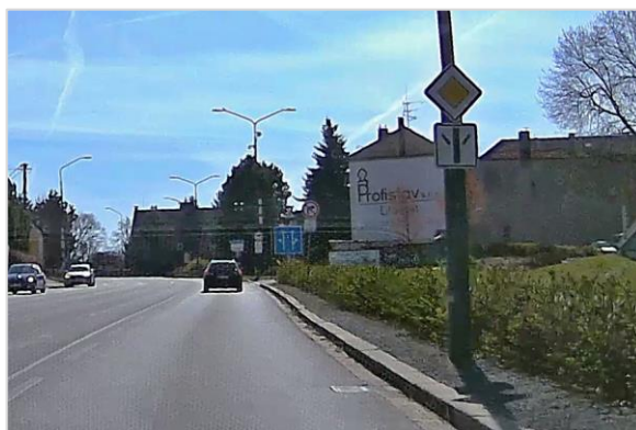
136/ Značka P2 umístěná 160 metrů od hranice křižovatky v obci (I/35: Litomyšl, Moravská)
