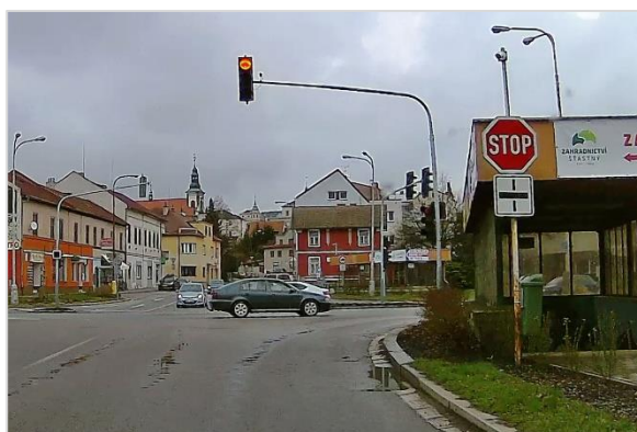
158/ Dodatková tabulka vyznačující obvyklý tvar křižovatky (II/315 x I/14: Ústí nad Orlicí)
