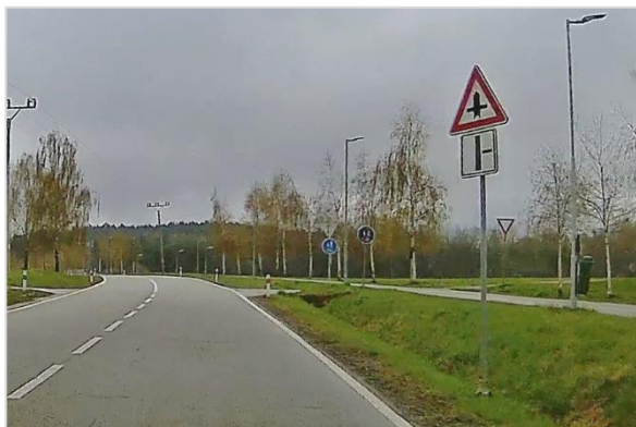
165/ Vyznačené jednostranné křižovatky v extravilánu dodatkovou tabulkou (II/315: Choceň – Zářecká Lhota)
